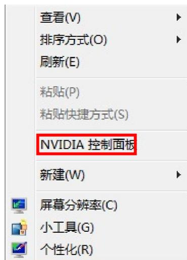
进入 NVIDIA 控制面板，在“显示”里点击“设置多个显示器”，已经勾上的显示器代表正在使用的显示器，如下图：
